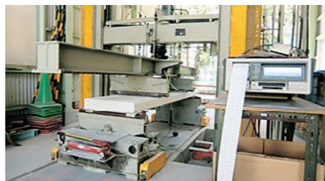
パネル曲げ試験の様子
