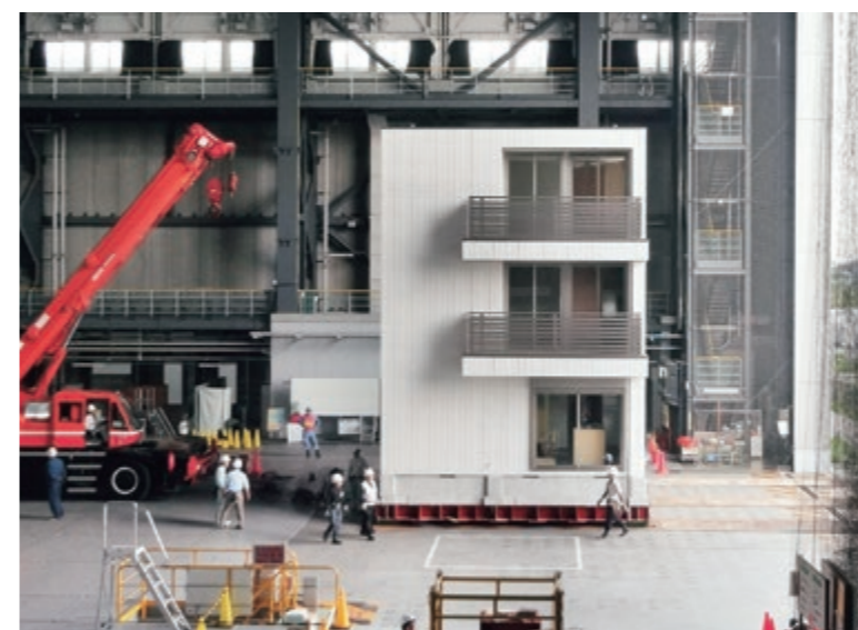
実邸を想定した面積・間取り、加重の3階建てを再現し、厳しく検証を行った
