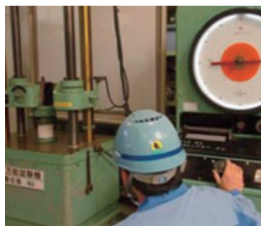
ヘーベルの圧縮強度測定の様子
