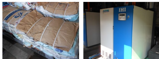
リサイクルのための廃プラスチック圧縮減容
